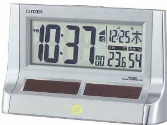
明るい場所では太陽光発電により電池の消耗を抑えます。
